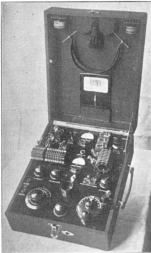
Det færdige Anlæg. I Laaget ses anbragt Telefon, Spoler og Log-Bog.
