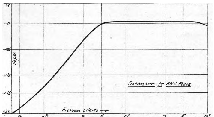
Frekvenskarakteristikken for en H. M. V.-Prøveplade, der viser Afskæring. gen fra ca. 500 Hz og ned. Afskæringen ved 40 Hz er ca. 30 Gange
