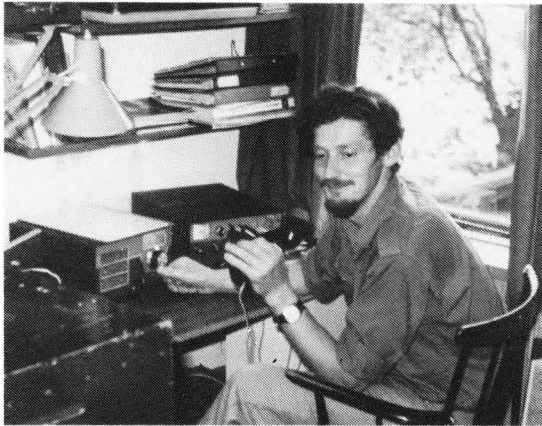
OZ6KF i Korup ved Rønde. Kristians antenner har tidligere været beskrevet i OZ, men det er vist første gang, vi ser operatøren på nært hold med hans station bestående af Drake TR-4 med remote VFO og hjemmelavet PA-trin.
