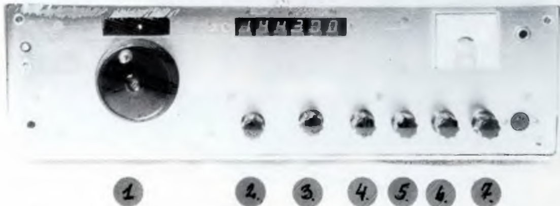
Forklaring til foto 3: (1) skala (modifieret LK drev) - (2) udvendig output regulering (100 mW til MAX) - (3) funktionsomskifter - (4) Mike gain - (5) Vox følsomhed - (6) SQUELCH - (7) LF-volumen.
