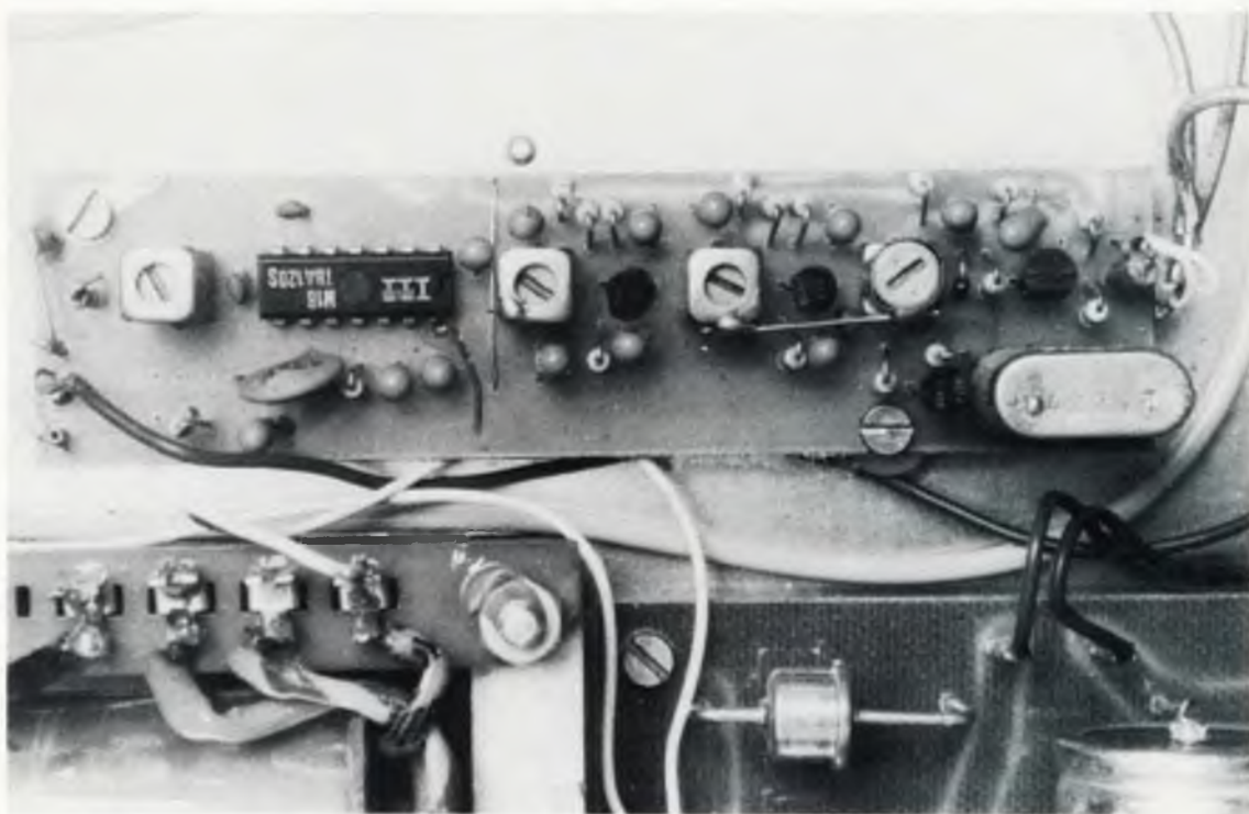
Foto 18: er ligesom billede 11, mellemfrekvensdelen af OZ9TM's modtager, hvor man tydeligere kan se min »snitflade«.
