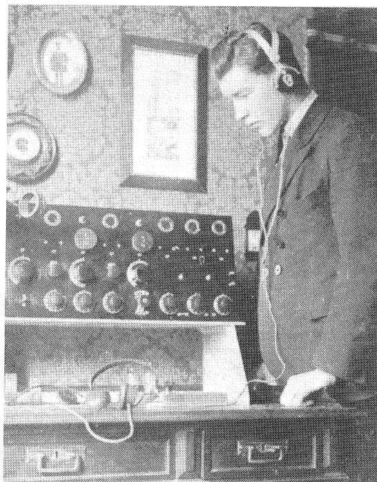
Loewe-modtager med 3-i-éen lampe fra 1927 til batteri og løs højtaler.
