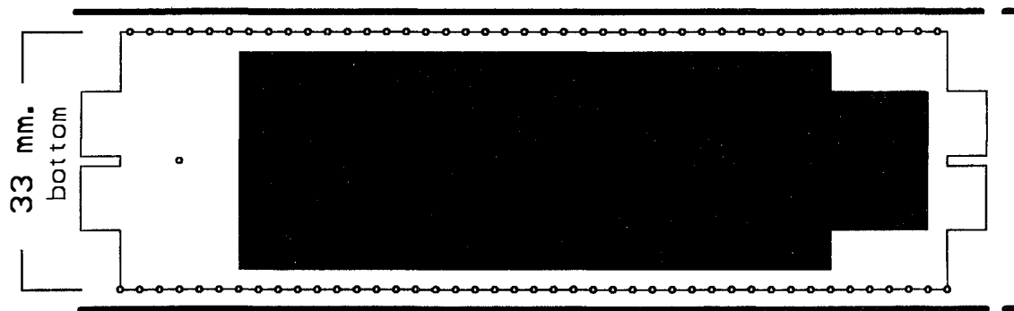
11.7 cm Condensatoren laves af Dobbelt sidet Photoprint
