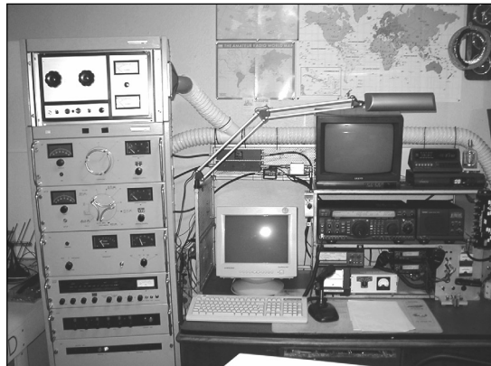
OZ1DPR's rig, som består af Yaesu FT920 til HF og 6 m. PA til HF er Elektromekano 1250/4CX1500B. PA til 6 m er homemade med GS35B. (Foto: OZ1DPR)
