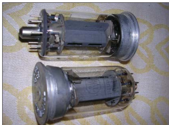
LS 180 med molybdænanode og med grafitanode. Det sidste sad i det omtalte PA-trin.
