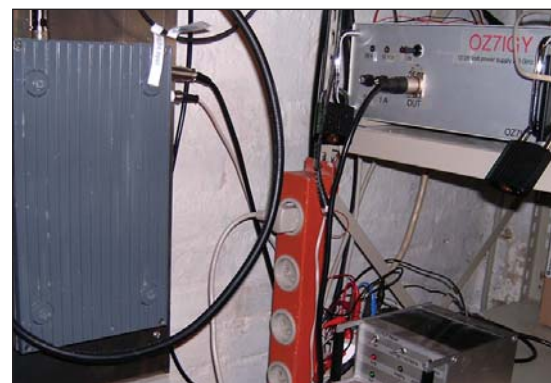
2320 MHz fyret: TV fyret spændt op på den store køleflade. TH strømforsyningen og på hylden derunder ses den centrale tegngiver.
