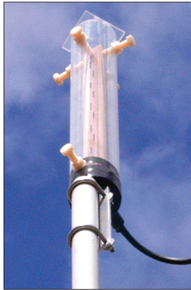
5,7 GHz antennen. Slotted bølgeleder, ca. 10 dBs gain.
