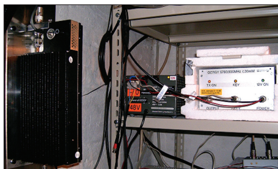
5,7 GHz PA trinnet på den store køleplade, 48 V forsyningen og styresenderen.
