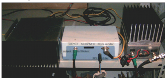
50 MHz opsætningen: 24 Volt PA strømforsyning, styresender og 40 Watt PA trin.
