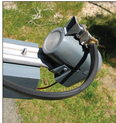
Her ses 24 GHz fødehornet monteret sammen med fødeantenne til 10 GHz på samme parabol.
