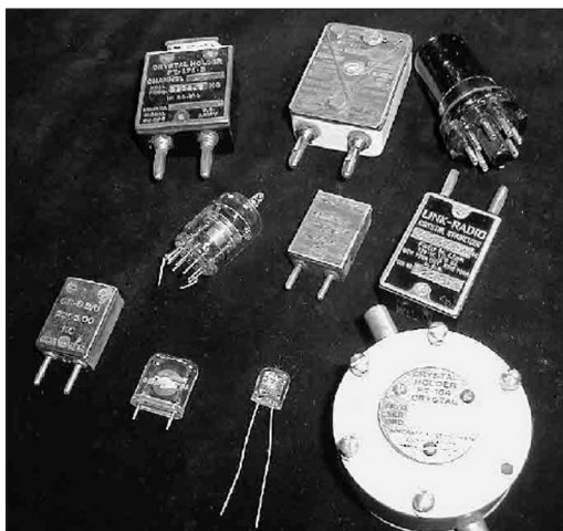
Figur 2. Eksempler på forskellige typer holdere, som bruges i krystaloscillatorer
