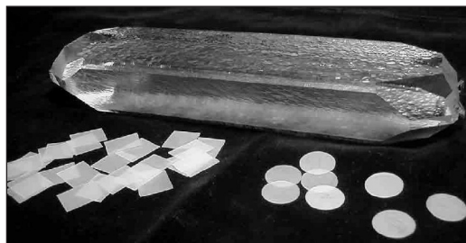
Figur. 1. En stang kunstig kvarts sammen med eksempler på den type skiver, som kan skæres fra den. (Stangen er 20,5 cm lang og 2,5 cm tyk. Skiverne er bare 0,35 mm tykke). Oversætter note: På billedet ser forholdet nærmere ud til at være 10,5 cm lang og 2,5 cm tyk. TR: Enig
