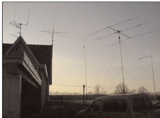
Antennefarmen ved skumringstide - dipoler til 40/80m og beam på 10/15/20m
