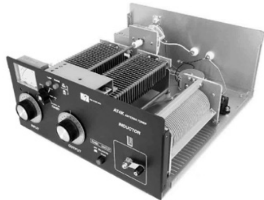
Figur. 5. Det indvendige i en Palstar AT4K
