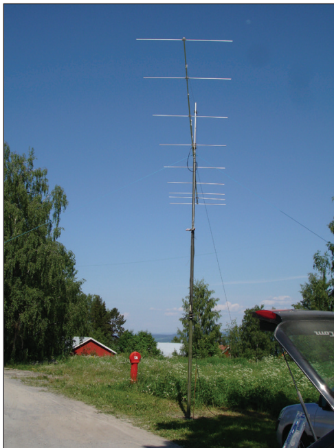
OZ2LD's 9 element yagi til 70 MHz samlet og opsat i Starum. Foto: OZ2LD
