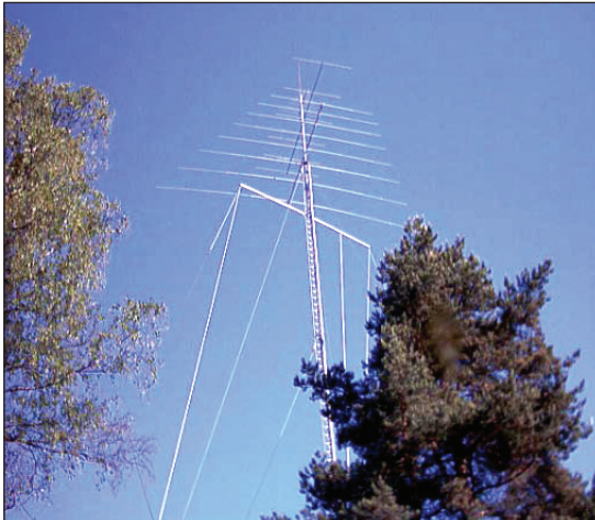
Antennefarmen på LG5LG. Øverst skimtes 6 meter-antennen, - en 6 elem. HB9CV. Nedenunder denne en 8 elem. logperiodisk antenne til HF (10 til 20 m).
