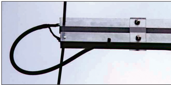
Forreste del af antennen; her ses elementerne, monteringsystemet for fødekablet og de forreste bom-isolatorer af plexiglas
