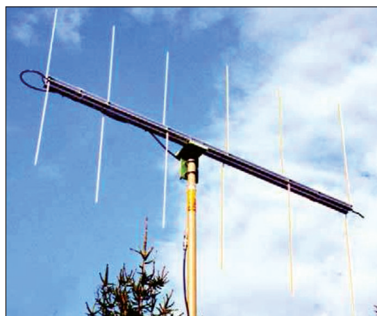
LPDA med vertikalt orienterede elementer. Brug kun denne orientering i forbindelse med en ikke-ledende mast
