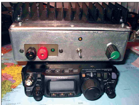
Figur 1 Det færdigbyggede PA oven på FT-817.
