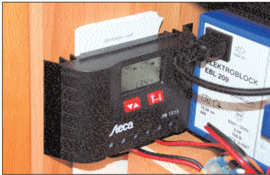
5A IN/OUT regulator med tilslutning for solcelle, batteri og load
