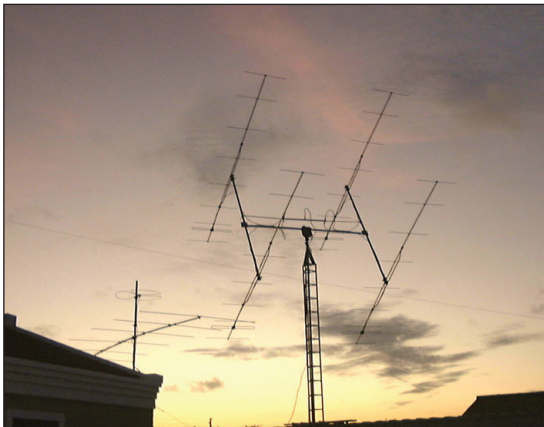
PJ4EME's antennesystem, som blev anvendt under DXpeditionen til PJ i juli 2007. 4 x 9 element Wimo. Foto modtaget fra PE1L.
