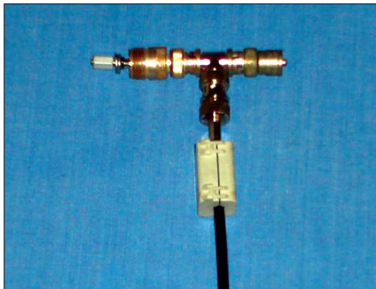
Figur 1. TR's "Matching Unit". Antennetråden tilsættes til venstre. Dimsen til højre er en 75 Ohm afslutning. Ferritkernen på kablet skal sikre, at det er pisken og ikke kablet der stråler
