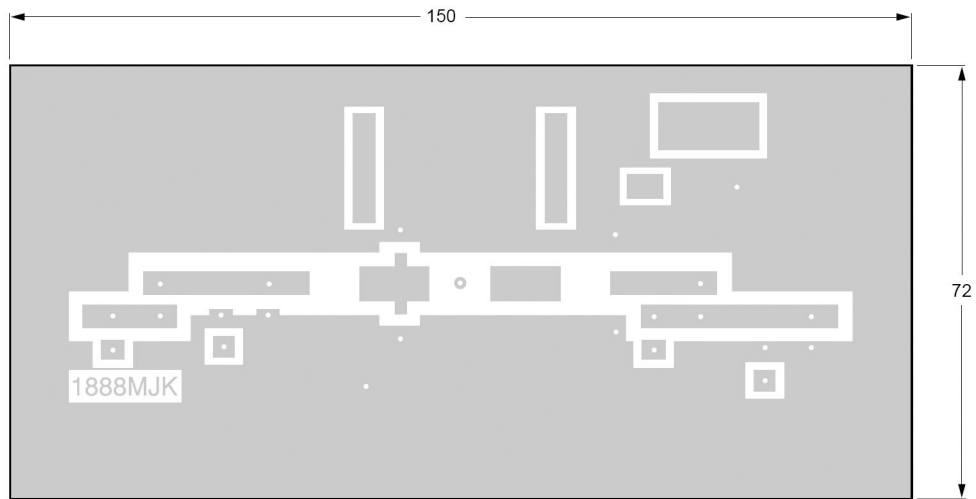
Fig 4 Print og komponentplacering PA-trin. Bemærk at printet er formindsket.
