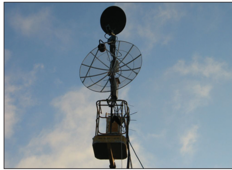
OZ1ALS 1,5m parabol til 23, 13 og 6cm. 65cm parabol til 3 og 1,2cm. "Stærekassen" bag den store parabol er 6cm transverterboksen.
