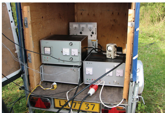
Trailer med 5P5T's to PA-trin, som var tilsluttet hver sit antennesystem.
