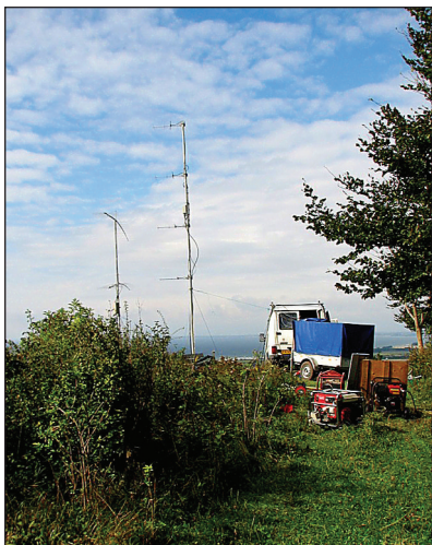
5P5T på Kongsbjerg på Møn (JO64GX), 135 m.o.h. Masten med 2x18 el. ses til venstre og masten med 4x4 el. til højre.
