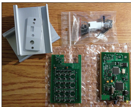
FiFi leveres som 2 printkort, en håndfuld smådele og et kabinet.
