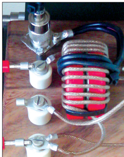
Figur 3. Toroidspolen med sekundærvindingen og tilslutning af coaxialkabel og paralleffeeder.
