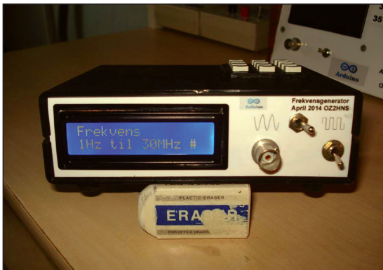
1Hz - 30MHz Værsgo'. Frekvens indtastning via tastaturet som lige kan anes på top lågets bagerste højre side.
