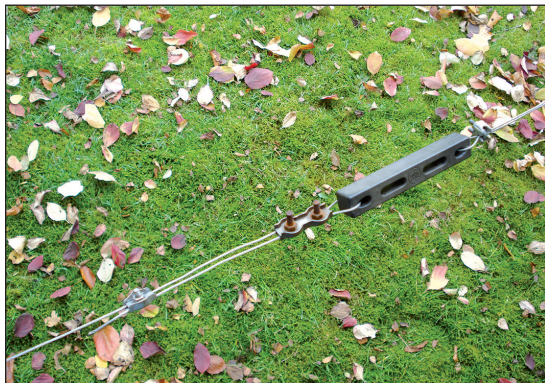
Figur 2. Afstemningspunktet for enden af antennen.
