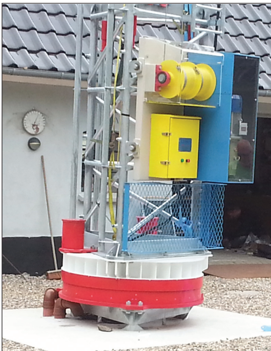
Bund af mast med rotor og hejsesystem.
